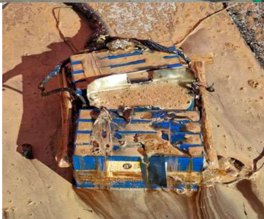
Figura 19: Estado de la batería después del ensayo 1.
