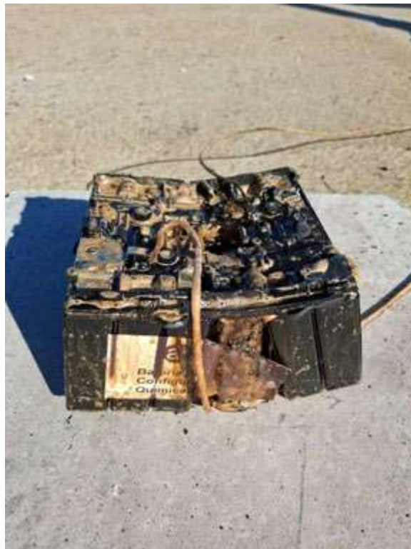
Figura 23: Estado de la batería después del ensayo 1.
