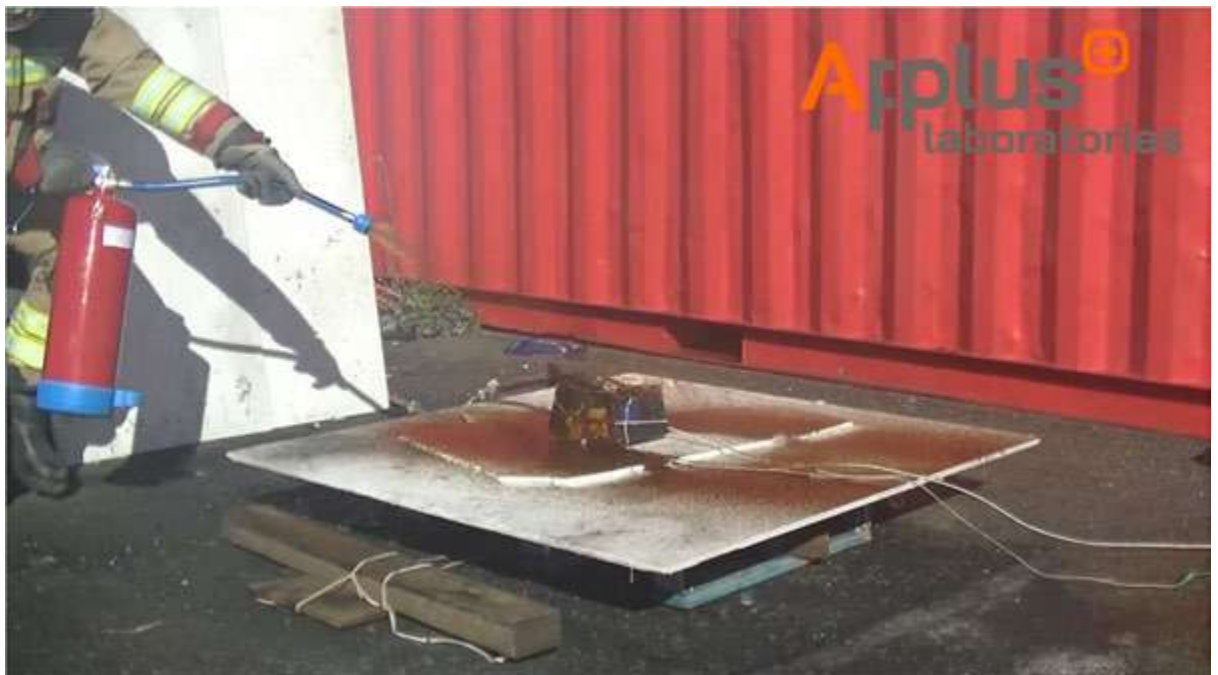
Figura 21: Batería en reacción ensayo 3.
