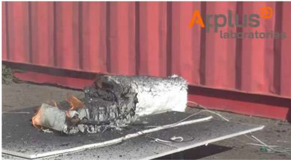
Figura 15: Estado de la batería después del ensayo 0.
