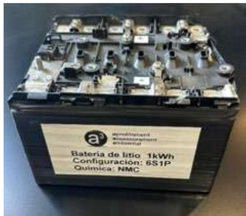
Figura 3: Carga de fuego de 1kWh.
