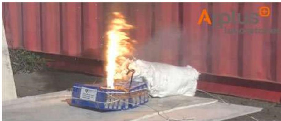
Figura 13: Batería en reacción ensayo 0.
