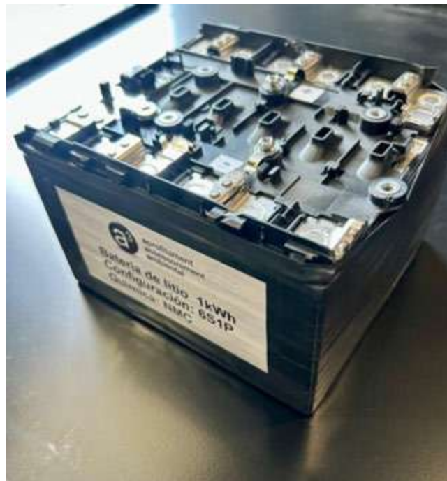
Figura 10: Batería de 1kWh para el ensayo del extintor de 6L.
