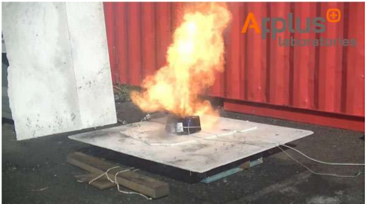
Figura 21: Batería en reacción ensayo 3.
