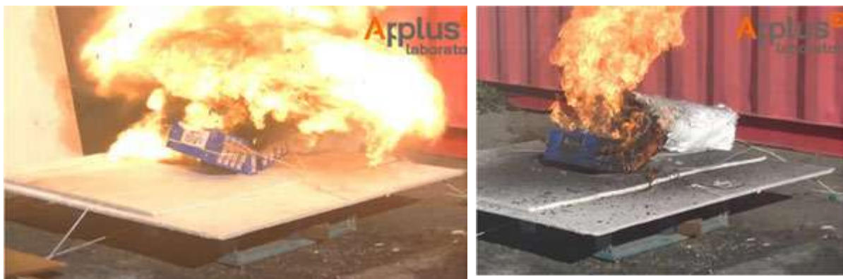
Figura 14: Propagación de la reacción de la batería en ensayo 0.
